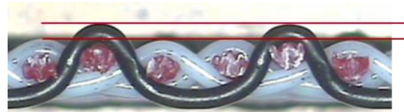
Abb.6b: Unebene Oberfläche eines Siebes mit Wettbewerbsmaterial Produktseite: antistatisches PA & PET auf unterschiedlichem Niveau- Maschinenseite: das antistatische Monofil hat eine bogenförmige Flottierung
