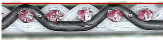
Abb.6a: Ebene Oberfläche eines Siebes mit AntiStat – Produktseite: AntiStat und PET auf gleichem Niveau; Maschinenseite: AntiStat bietet eine flache und stabile Flottierung
